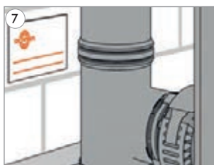
Brandschutzschild ausfüllen und so anbringen, dass es beim Entfernen der Einhausung sichtbar wird. Übereinstimmungsbestätigung ausfüllen und dem Bauherren übergeben.
